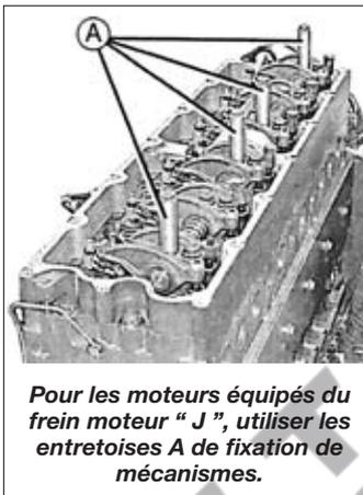
**Pour les moteurs équipés du frein moteur " J ", utiliser les entretoises A de fixation de mécanismes.**
