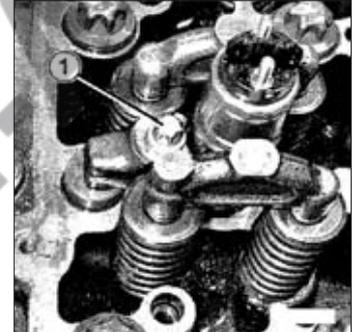
**Dépose de la vis (1) de bride d'injecteur**
