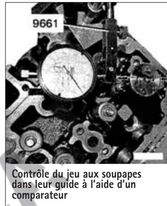
**Contrôle du jeu aux soupapes dans leur guide à l'aide d'un comparateur**
