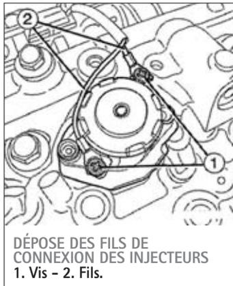
**DÉPOSE DES FILS DE CONNEXION DES INJECTEURS**
