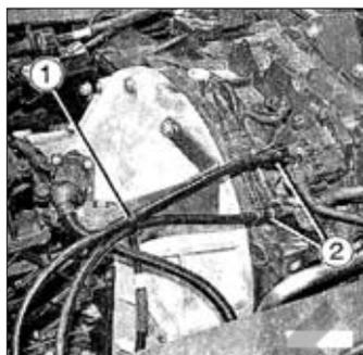
Dépose des tuyauteries d'alimentation et de retour de combustible
